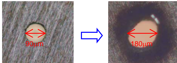
図6.7.4 繰り返し照射前後の貫通孔裏面の光学顕微鏡観察結果
