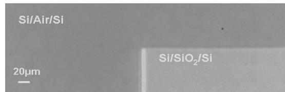
図 6.8.25 貼り合わせ SOI ウエハの埋め込み酸化膜パターンのエッジの光散乱トポグラフィおよび顕微鏡透過観察結果
