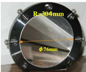
図 6.8.11 曲率半径 304mm の球面ミラーの保持
