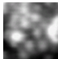
図 6.9.7 光照射下での STM 観察により得られた水素化アモルファスシリコン表面の原子スケール輝点
