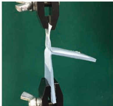
剥離試験中(側面)
