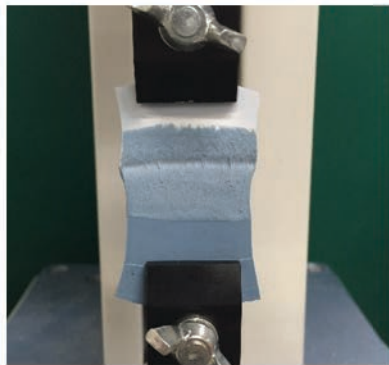
剥離試験中(前面)
