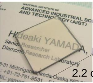
近年、この方法を発展させて産総研で数cm角（最大20 mm×40mm）の単結晶ダイヤモンド基板を作る方法が確立されました。
